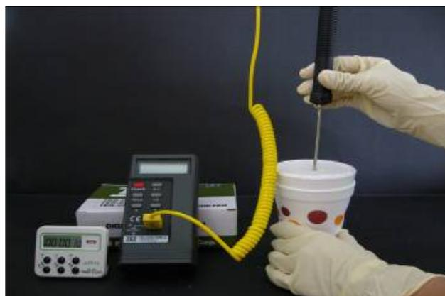
圖 7-3 使用卡計和電子溫度計
