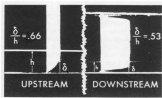
圖 13. 在圖 12 上游及下游邊界層剖面的複合放大。
