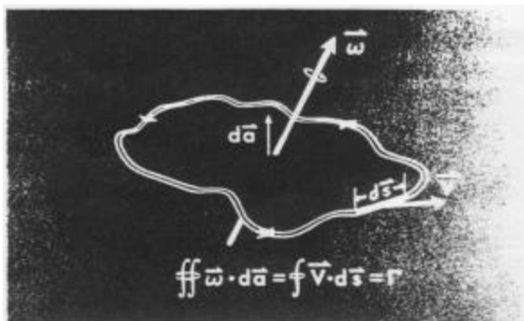
圖 9. 渦度 \omega 的面積分等於速度繞著封閉曲線的線積分。
