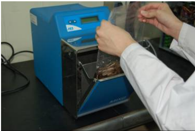
圖60-2 加入無菌peptone water以鐵胃混合。
